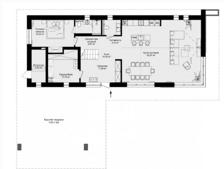
Экспликация помещений 1 этажа
